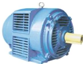
Защищенные общепромышленные асинхронные короткозамкнутые электродвигатели **серии 5АИИ со степенью защиты IP23** отличаются от обычных и более распространенных двигателей с IP54 или IP55 прежде всего тем, что при одинаковых мощности и частоте вращения вала обладают меньшими размерами.
