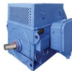
Электродвигатели асинхронные с короткозамкнутым ротором **серии ДАЗО4** для работы от сети переменного тока напряжением 3000 В, 6000 В и 10000 В, предназначены для привода механизмов с тяжелыми условиями пуска, а также для привода насосов, воздуходувок, вентиляторов, дымососов и других механизмов.
